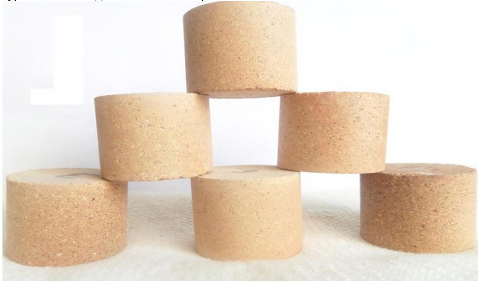
Рисунок 2 — Опытные образцы огнеупорных глин в виде цилиндрических стержней (размер 40x50мм)
